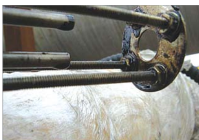
Рис. 8. Расходомер, установленный до сепаратора, после залпового сброса
