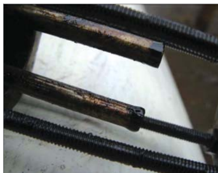
Рис. 4. Расходомер, установленный до сепаратора, за 10 дней работы
