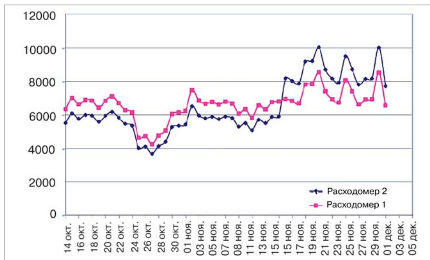
Рис. 10. Сравнение показаний работы расходомеров (расходомер 1 установлен до сепаратора, расходомер 2 – после. 16.11.2011 г. была произведена перестановка расходомеров местами)
