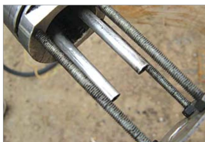
Рис. 9. Расходомер, установленный после сепаратора, после залпового сброса
