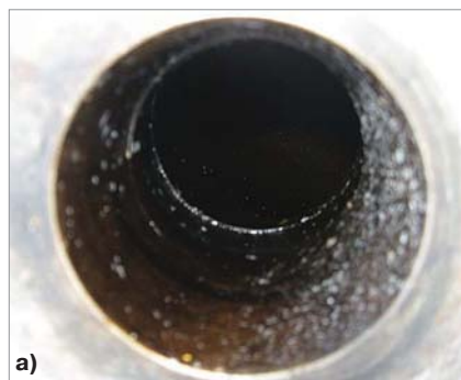
Рис. 6. Внутренняя часть трубопровода до сепаратора (а) и после сепаратора (б)
