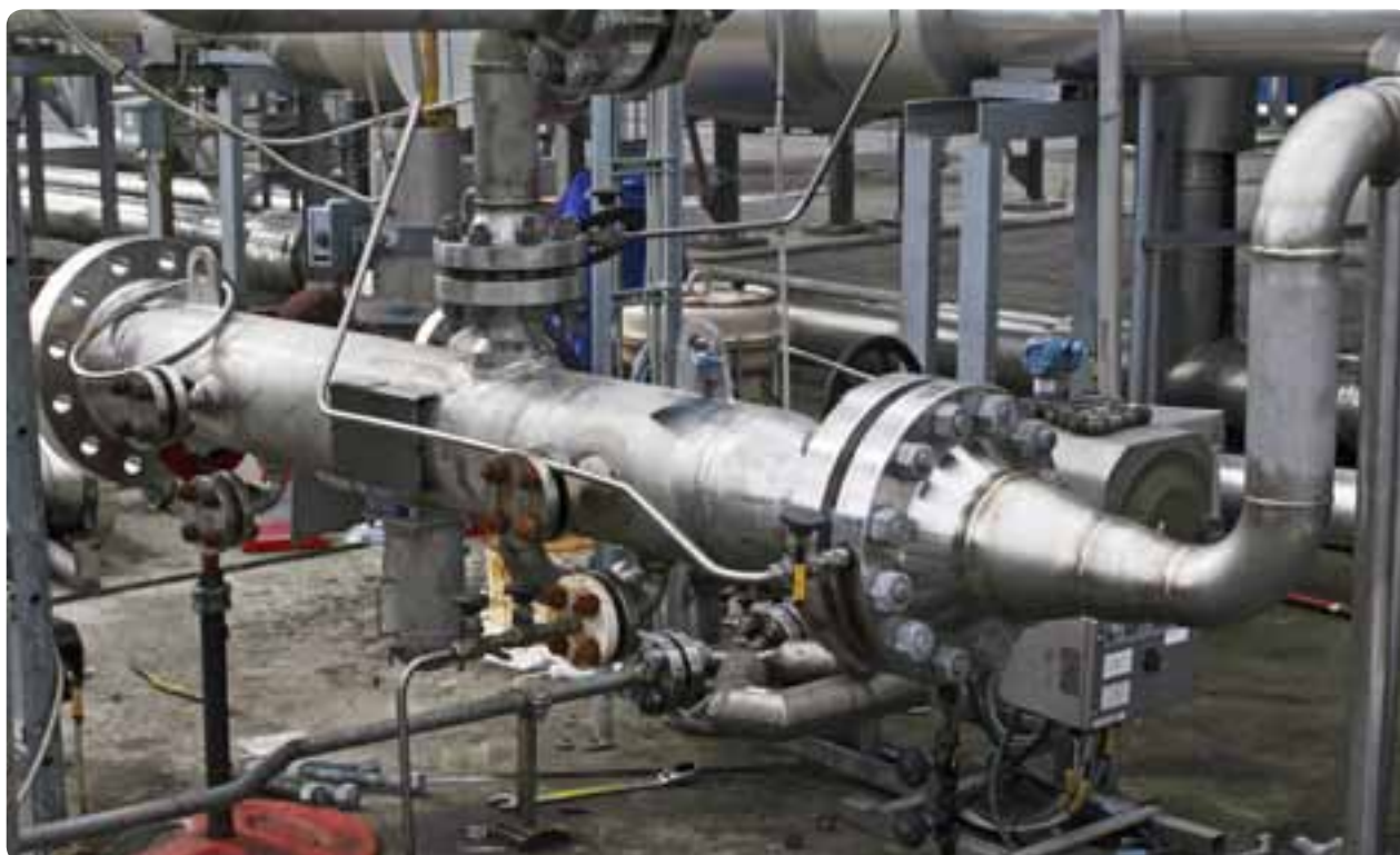
Сепаратор InLine DeWaterer на испытательном полигоне. Производительность сепаратора 10-40 м3/ч.
