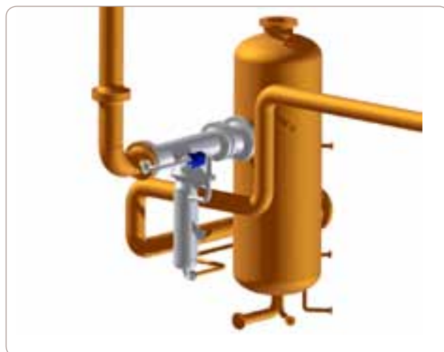
Сепаратор InLine DeLiquidiser в эксплуатации на платформе EТАР
